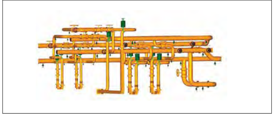
Resim D: Yaylı askılara ve desteklere sahip bir boru sistemini gösteren yazılım modeli
